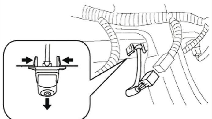
**6** При помощи острого предмета отогните **2 фиксатора** крепления провода к камере и отсоедините провод. Открутите **2 винта** крепления камеры к кронштейну. Установите камеру на новый кронштейн и закрутите **2 винта**. Установите камеру с кронштейном в штатное место. Присоедините провод камеры.
