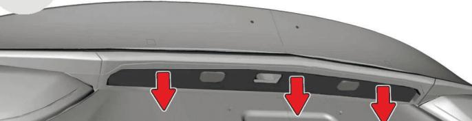
**3** Крестовой отверткой поверните против часовой стрелки **3 клипсы** и снимите их. Выверните **3 болта**.
