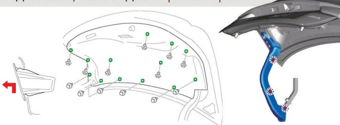
**2** Снимите нижнюю наружную накладку двери багажного отделения.
