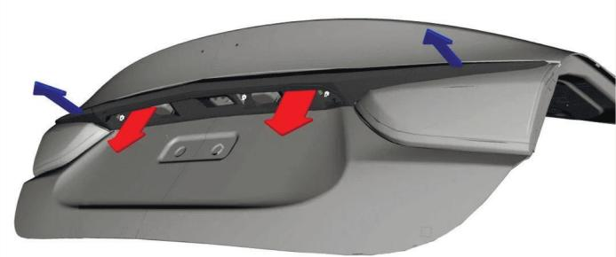
**5** Освободите 2 захвата и снимите заднюю камеру в сборе. Отсоедините **разъём**.
